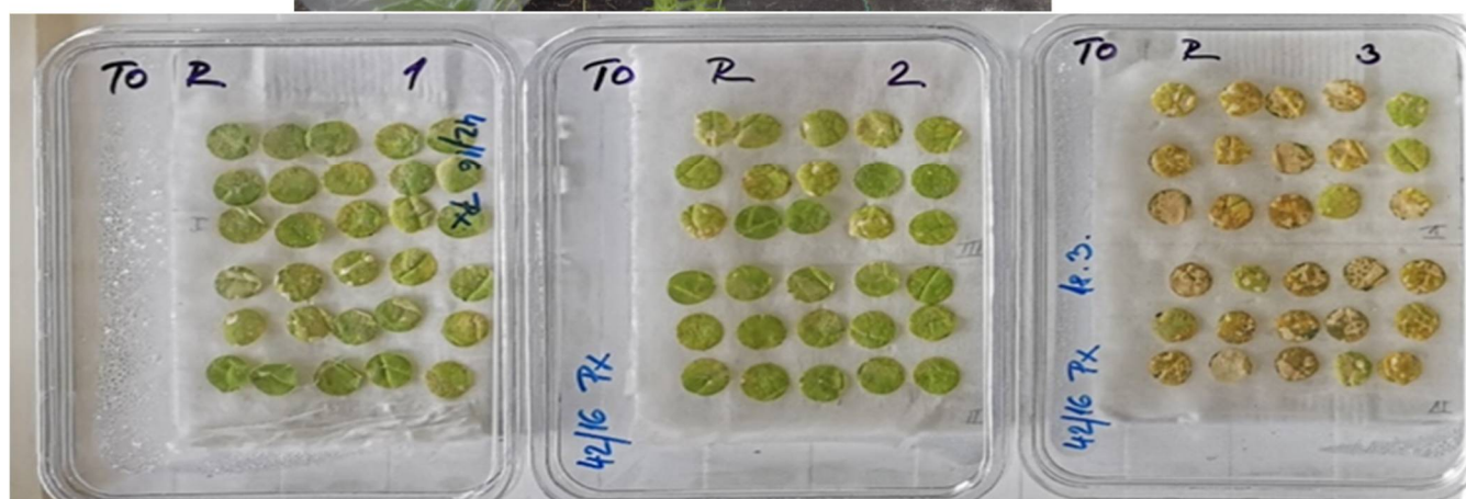
Obr. 15: Metoda 1: Testování účinků emulzí EO (0,2%-0,6%) metodou postřiku listů, kultivace v plastových krabičkách (podle Loubové, 2022) (A: listy bez sáčků, B: listy pokryty sáčky), C: Testováno padlí dýňovitých (izolát P. xanthii ), tymián koncentrace 0,025%-0,2%); foceno 12 dnů od inokulace
