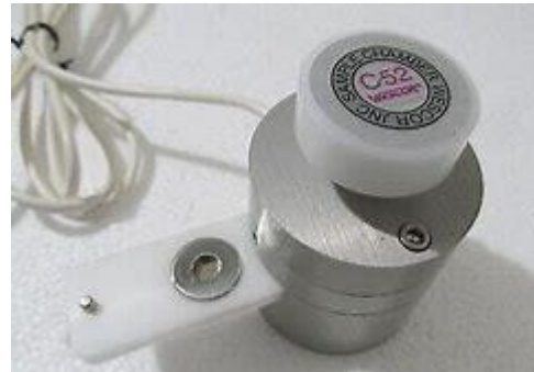
Obr. 6 Psychrometrická komůrka C-52 (Wescor, USA) pro měření vodního potenciálu listů.
